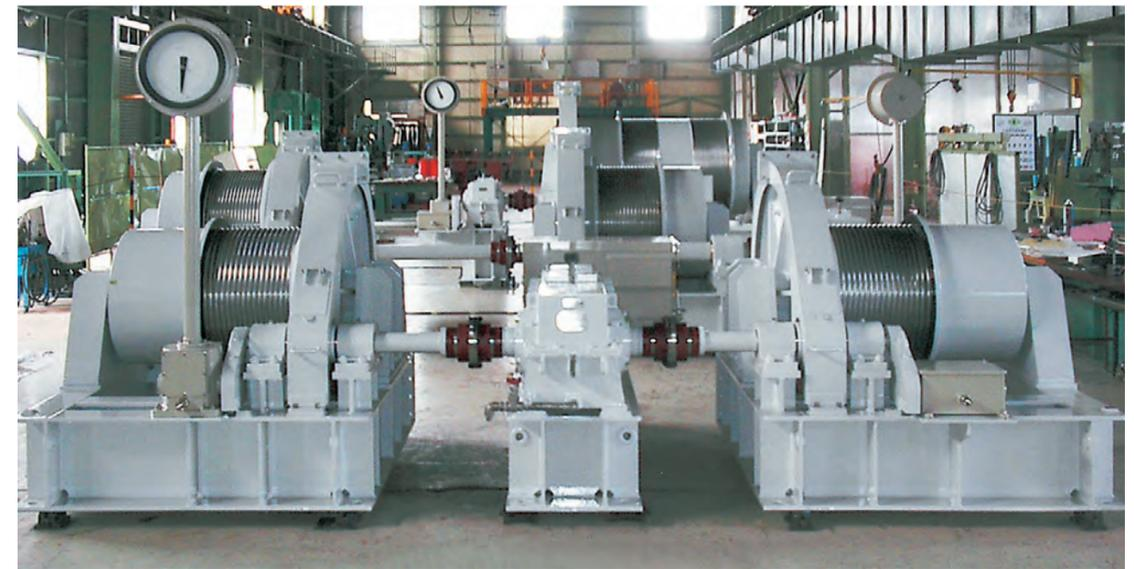
型式：ワイヤードラム式 1モーター2ドラム×5門 操作方法：機側操作 開閉方式：電動
